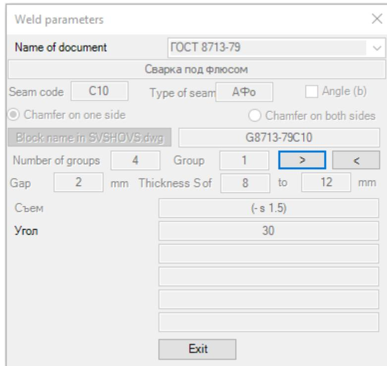
**Figure 157. Weld parameters dialog box**
