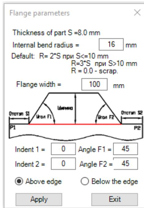
**Figure 154. Flange parameters** dialog box
