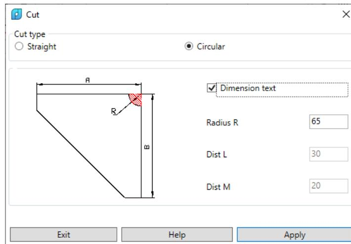
Pic. 43. Radial cut parameters
