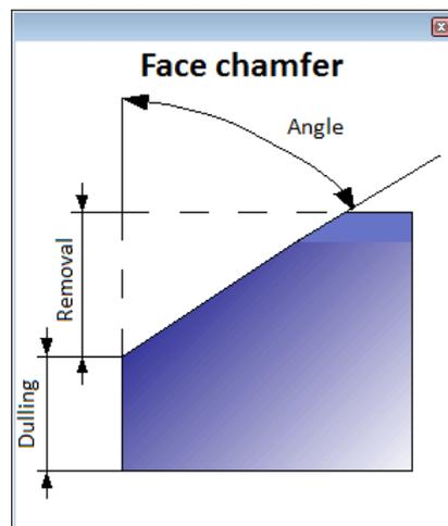
Pic. 99. Face chamfer parameters
